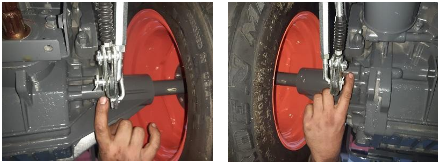
Widok mechanizmu hamulca pomocniczego tylnej osi
